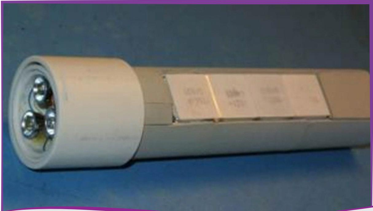
Inventó el "Hollow Flashlight", una linterna que funciona sin pilas; emite luz utilizando tan solo el calor de la mano
